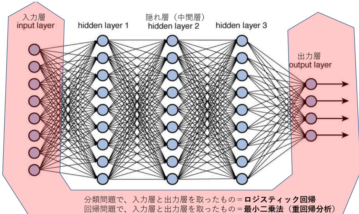
図は[\*3]より引用、加工した。このようにたくさんの点（ニューロンという）をつなぎ合わせて、網目状に構成したのが多層パーセプトロンだ。縦のニューロンの塊を**層**（Layer）といい、**最初の層**を入力層、最後の層を出力層という。入力層と出力層の間を**中間層**という。中間層の間で呼び方の差は特ない。
