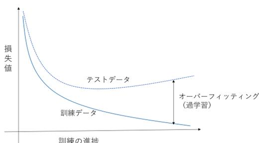
一般的には、訓練データに対する損失値 (訓練損失)、テストデータに対する損失値 (テスト損失) に対して左図のような関係が成り立つことが多い。
