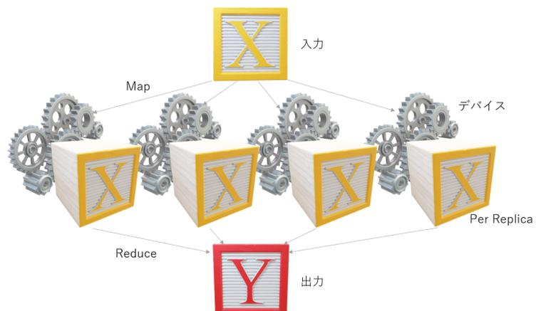
デバイス単位で32個ずつのデータを計算する。この方式を**Data Parallel**という。モデルが複数個ある場合は、モデル1をデバイスAが、モデル2をデバイスBのように計算するという方式もあり、これは**Model Parallel**という（大事なのは、モデルの中身をばらしてデバイス単位で分割計算はせずに、モデル単位で分割するか、サンプルを分割して計算するかということである）。ここではモデルが1個しかないのので、Data Parallelだけを考える。
