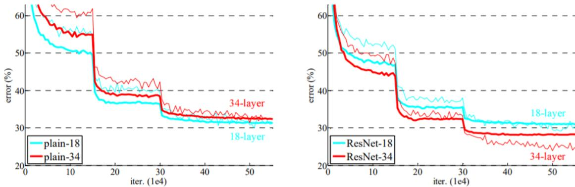
縦軸がエラーレート（1-精度）、横軸が訓練の進行を表す学習曲線である。左が特ににも工夫しない場合だ。34層の畳み込み層を持つモデルより、18層の畳み込み層を持つモデルのほうが一貫して精度が高くなっている。これは困った問題で、34層のほうがモデルとしては高価なのだから、18層よりも精度が高くなってほしい。なぜ、34層のモデルは精度が出にくいのかというと、勾配の爆発や消失という別の問題が起きているからである。
