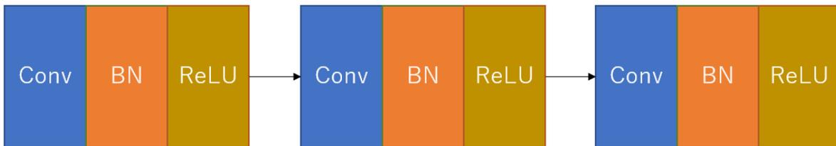
「Conv→Batch Norm→ReLU」のブロックを何度も繰り返していく。ただし、これでは解像度が変わらないので、ダウンサンプリングのレイヤーをはさむ。これをPooling層という。
