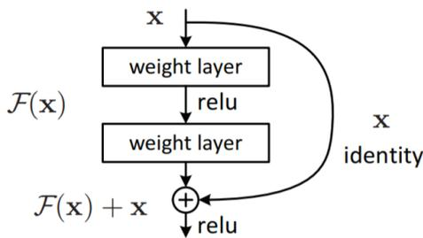
これを解消したのがResNetにおける、Residual Blockで、学習曲線は右側のグラフにあたる。Residual Blockを導入することで、18層モデルよりも34層モデルのほうが精度が高くなり、レイヤー数と精度が連動するようになる。ではResidual Blockとはどういったものかということ、左の図のような構造だ。「Weight Layer」というのはConv2Dのような畳み込みレイヤーを指す。このように一定間隔で前の（この説明では2レイヤー前の）畳み込み出力と足すということを行う、いわばバイパスのような構造を適宜入れているのが特徴である。このバイパスの結合を、Skip Connectionという。Residual Blockを積み重ねていったのがResNetである。
